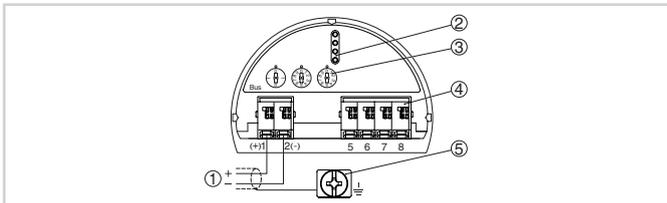
Отсек электроники и подключения (однокамерный корпус)
